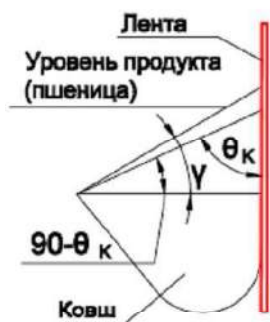
Рис. 9 – Вариант заполнения ковша с \psi \geq 1 при его выходе из слоя СМ на вертикальном участке подъема
