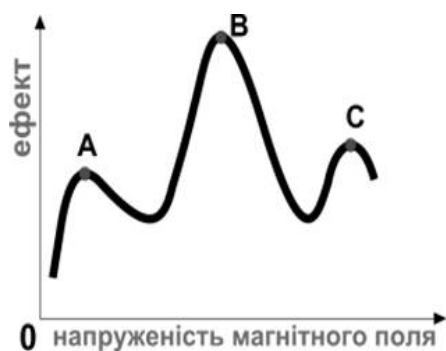
Рис.1 – Поліекстремальна залежність ефекту магнітної обробки від напруженості магнітного поля
