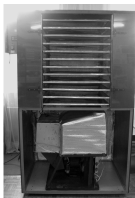
1 – сушильна камера; 2 – випарник; 3 – збірник конденсату; 4 – компресор; 5 – конденсатор; 6 – дросель
