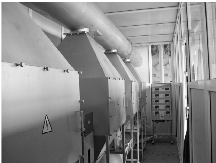
Рис. 1 – Опытный образец установки Ш12 - ЭРУОВ для очистки дурно пахнущих вентиляционных выбросов при производстве сухих животных кормов
