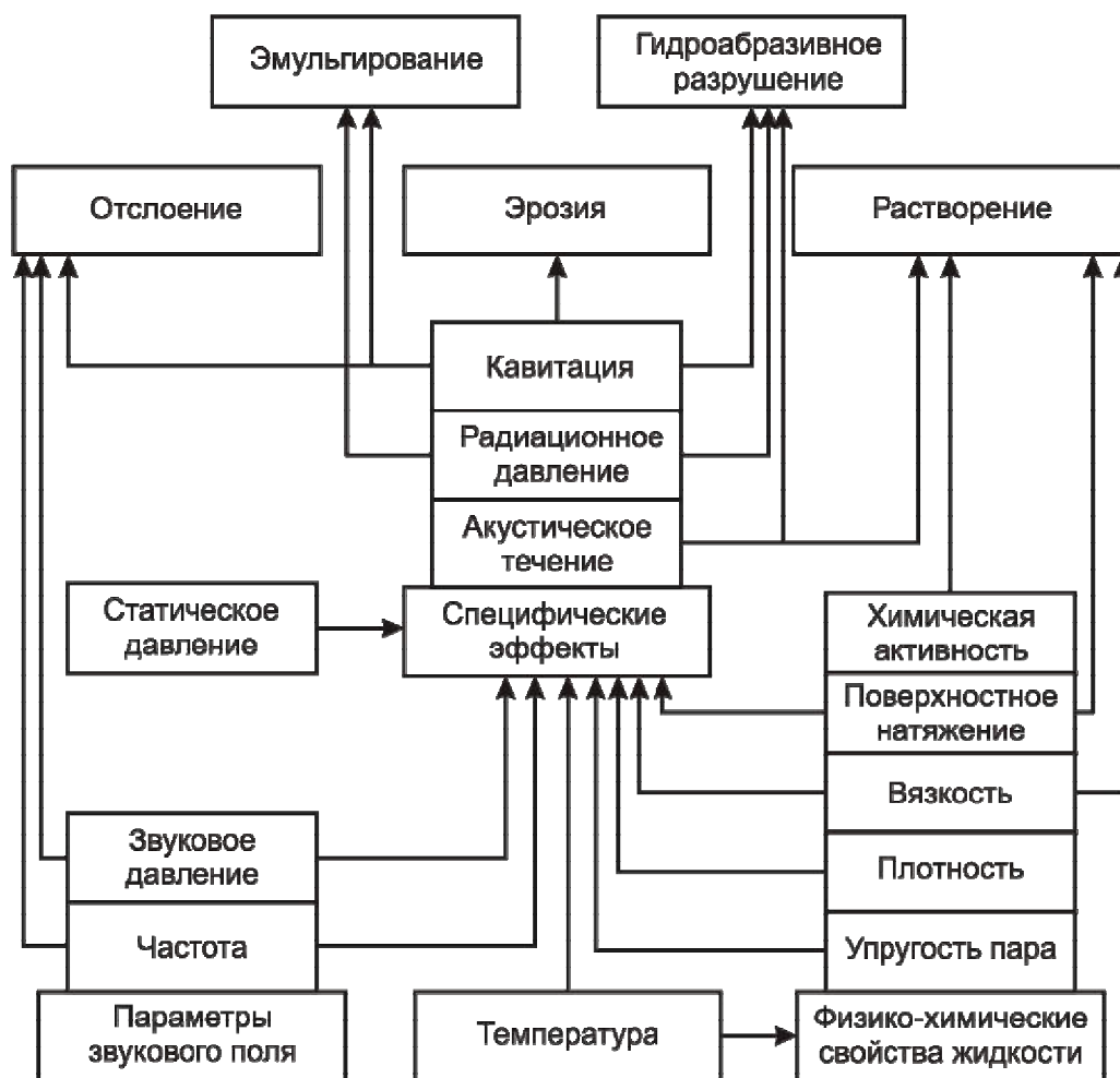
Рис. 1– Влияние различных факторов на механизм ультразвуковой очистки
