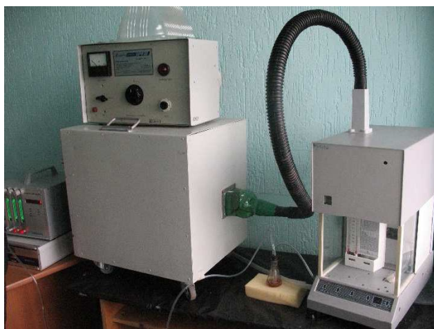
Рис. Установка для обработки суспензии конидий Aspergillus niger
