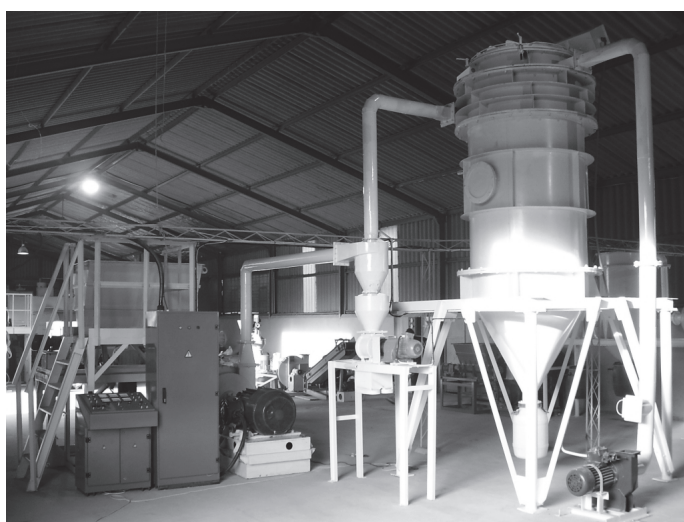
Рис. 6 – Установка совмещенного процесса тонкого измельчения и сушки растительных отходов
