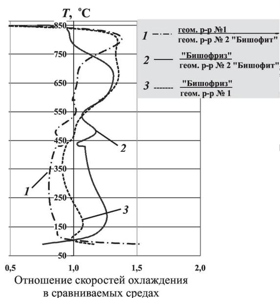
Рис. 3 – Интенсивность охлаждения в средах на геоминеральной основе
