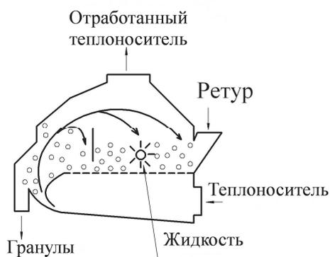
Рис. 6 - Гранулятор с сепарацией гранул в вихревом слое
