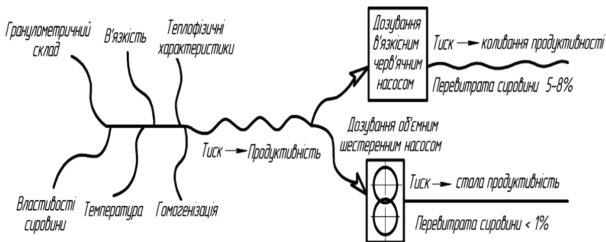
Рис. 2 – Схематичне представлення проблеми пульсації продуктивності в класичному черв'ячному екструдері та в екструдері з шестеренним насосом.
