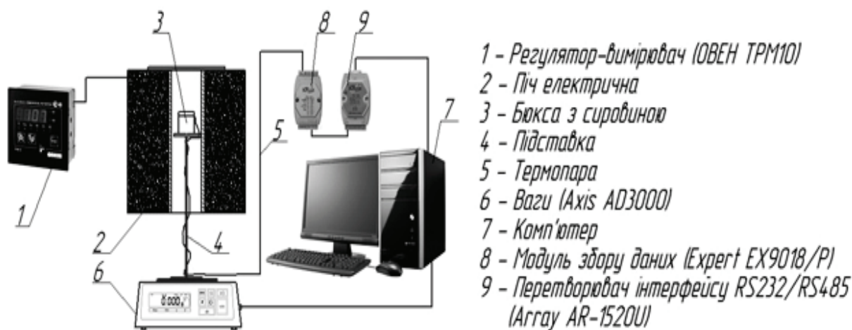
Рис. 1 – Дослідний стенд експериментальних досліджень температурної обробки
