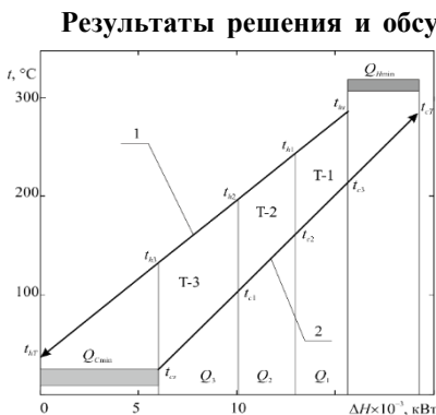
Рис. 2. Температурно-энтальпийные профили теплоносителей двухпоточковой системы теплообмена.
