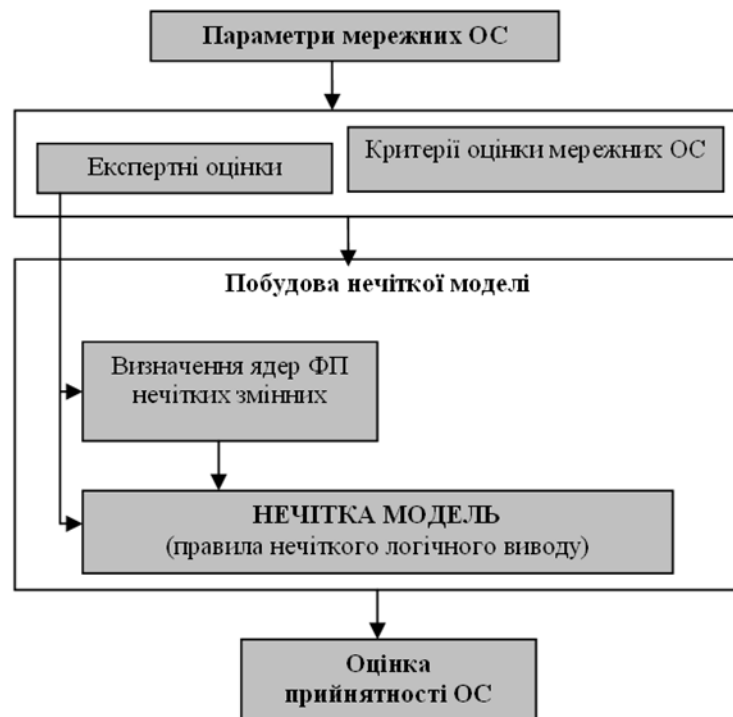
Рис. 1. Структурна схема вибору апаратно-програмного комплексу
