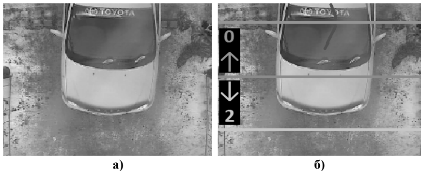
Рис. 2. Результат обчислення кількості і визначення напрямку руху автомобілів: (а) – кадр відеопотоку; (б) – результат роботи алгоритму
