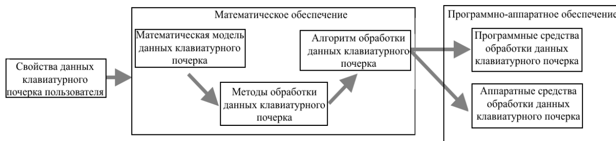
Рис. 1. Этапы разработки и создания системы биометрической аутентификации по клавиатурному почерку
