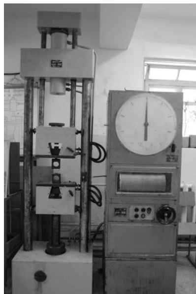
Рис. 3. Установка для пресування дослідних зразків пористих матеріалів з різною пористістю
