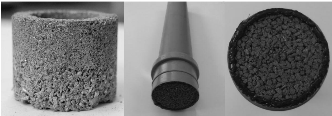
Рис. 5. Спресований зразок поміщений у пластикову водопровідну трубу
