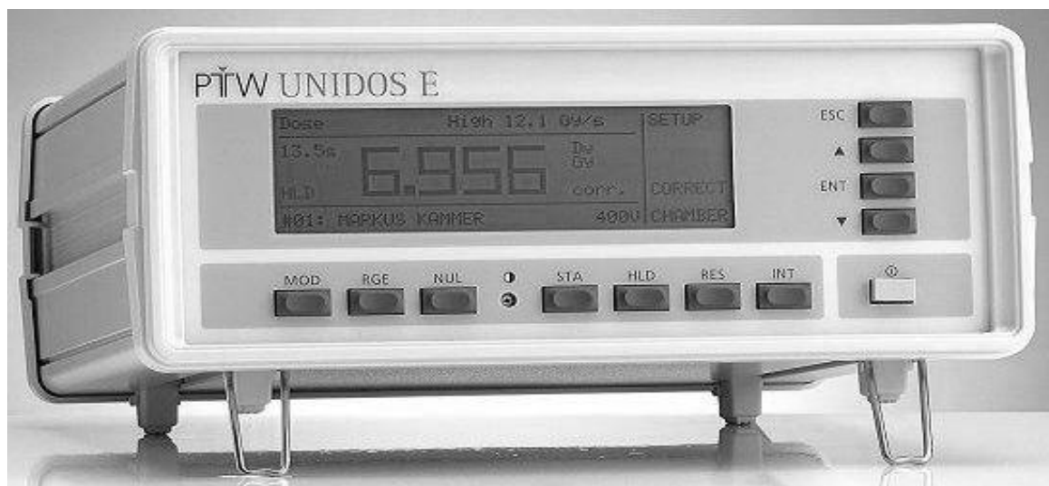
Рис. 1. Универсальный дозиметр PTW-UNIDOS E
