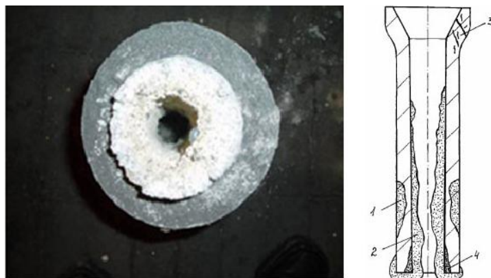
Рисунок 6 – Фотографія заростання внутрішньої порожнини погрузного стакану включеннями глинозему (а) і схематичне зображення характеру зносу погрузного склянки в процесі розливання (б)
