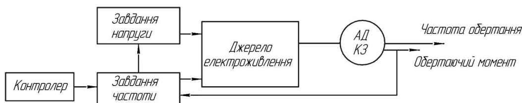
Рисунок 1 – Функціональна схема асинхронного приводу шахтного електровозу.
