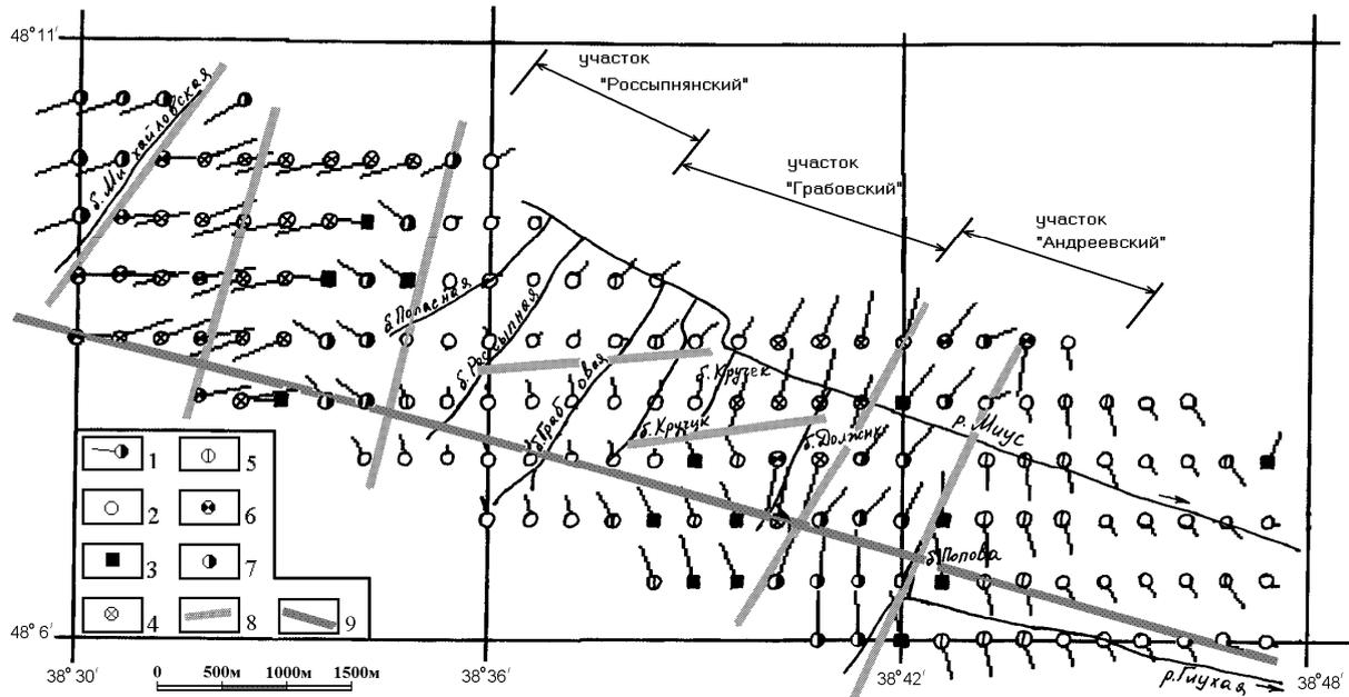
**Рис. 2.** Схема поля суммарных тектонических деформаций центральной части Ольховатско-Волынецовской антиклинали (ось укорочения): 1 — точки расчета параметров поля деформаций с направлением одной из осей деформаций; 2–7 — тип поля деформаций: 2 — сбросовый, 3 — октаэдрический, 4 — сдвиговый, 5 — сбросо-сдвиговый, 6 — взбросо-сдвиговый, 7 — взбросо-сбросовый, 8 — выделенные нединамические зоны, 9 — ось антиклинали
