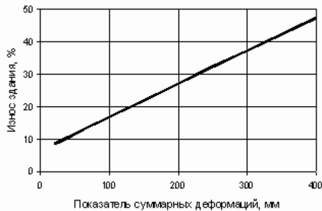
Рис. 2 Зависимость износа здания от показателя суммарных деформаций.
