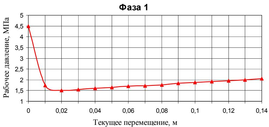
Рис. 3. Изменение рабочего давления при перемещении бойка на фазе 1
