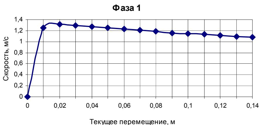
Рис. 2. Изменение скорости бойка при перемещении на фазе 1
