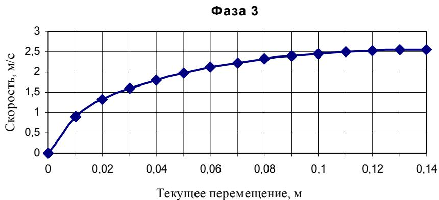
Рис. 4. Изменение скорости бойка при перемещении на фазе 3
