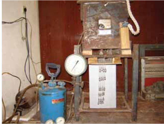
Рис. 1 Общая вид модели с пневматическим оборудованием: 1 – стенд модели; 2 – экран для фотофиксации смещений контурных реперов; 3 – компрессор; 4 – аккумулирующий накопитель воздуха
