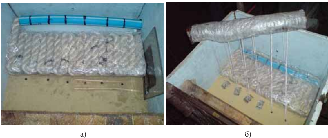
Рис. 3. Общий вид ящика внутри модели при расположении в нем капронового каната с извлекаемой направляющей пластиковой трубой (а) и комплекта арочной металлической крепи с нитями-тяжками контурных реперов (б)
