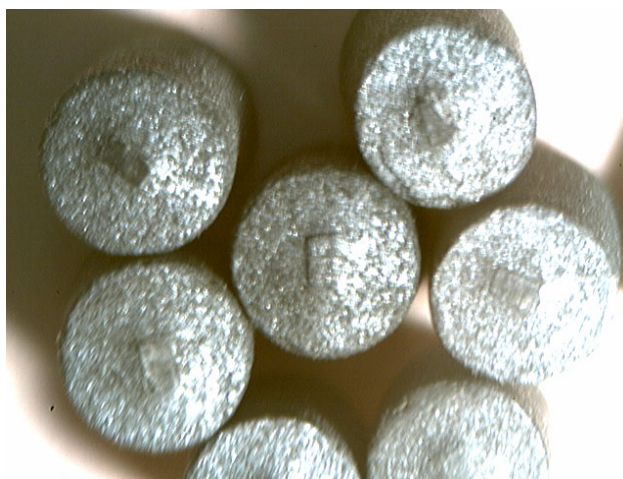
Рис.1. Общий вид цилиндрических породоразрушающих элементов ГАКТПМ.
