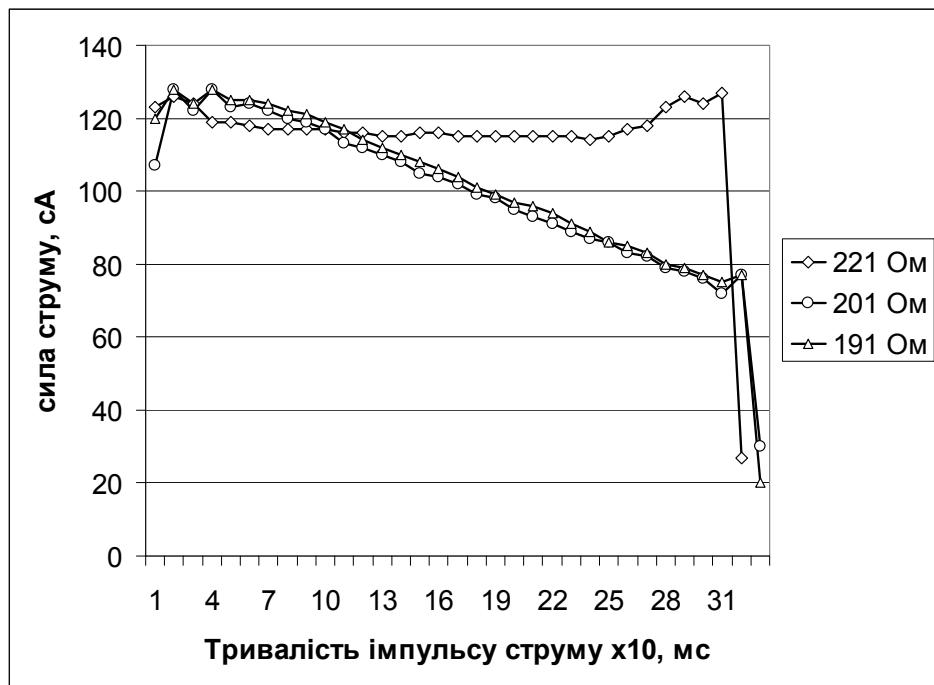
Рис. 2 – Зображення імпульсів струму при різних опорах ланцюга
