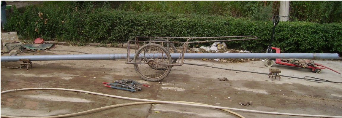
Рис. 1. Снаряд для отбора гидратосодержащего керна, разработанный в Цилинском университете КНР
