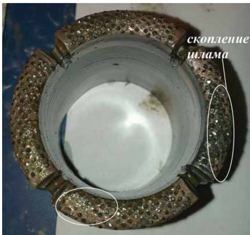
Рисунок 4 – Пример скопления шлама на сбегающей части сектора коронки
