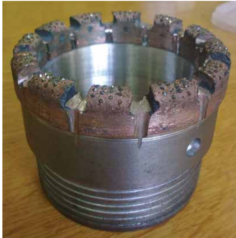
Рисунок 6 – Опытный образец коронки диаметром 93 мм, оснащённой синтетическими алмазными монокристаллами зернистостью 1600/1250 мкм.
