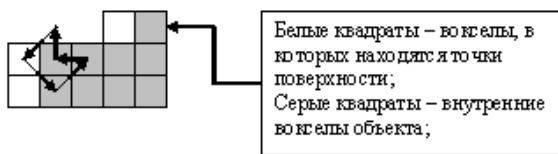
Рисунок 6 – Обход вокселей при поиске следующего направления движения
