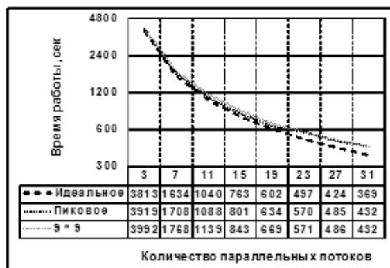
Рисунок 5 – График изменения времени работы параллельной программы в зависимости от числа потоков.
