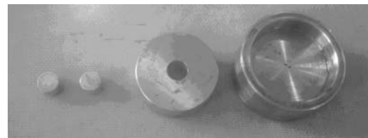
Рисунок 2 – Штемпельний прилад для випробувань вибухових речовин на стійкість до удару
