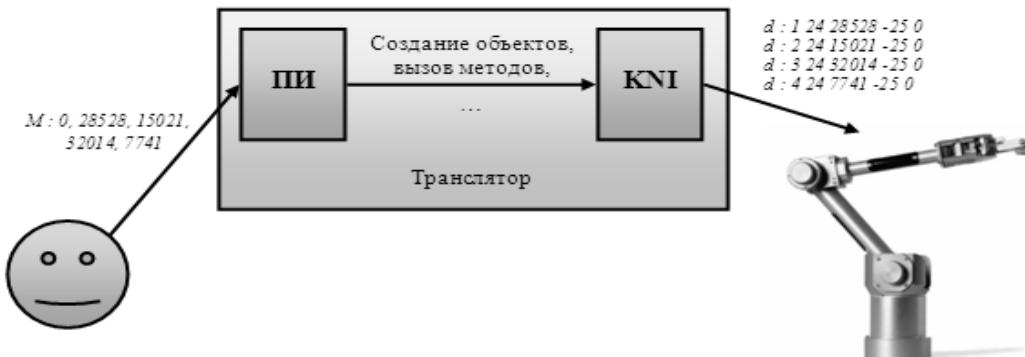
Рисунок 4 – Схема работы ПО управления роботом-манипулятором
