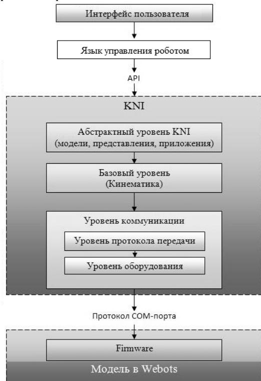
Рисунок 2 – Архітектура ПО управління роботами-манипуляторами фірми Neuronics AG
