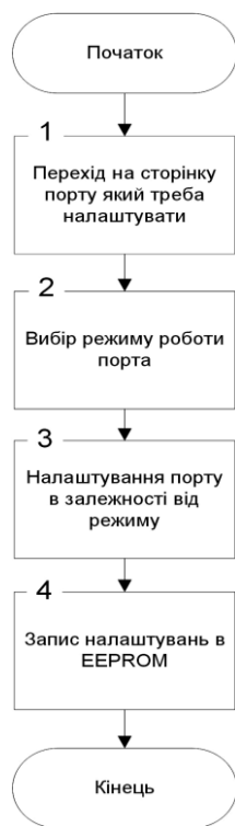
Рисунок 7 – Налаштування режиму роботи порту
