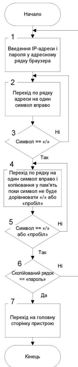
Рисунок 6 - Алгоритм перевірки пароля
