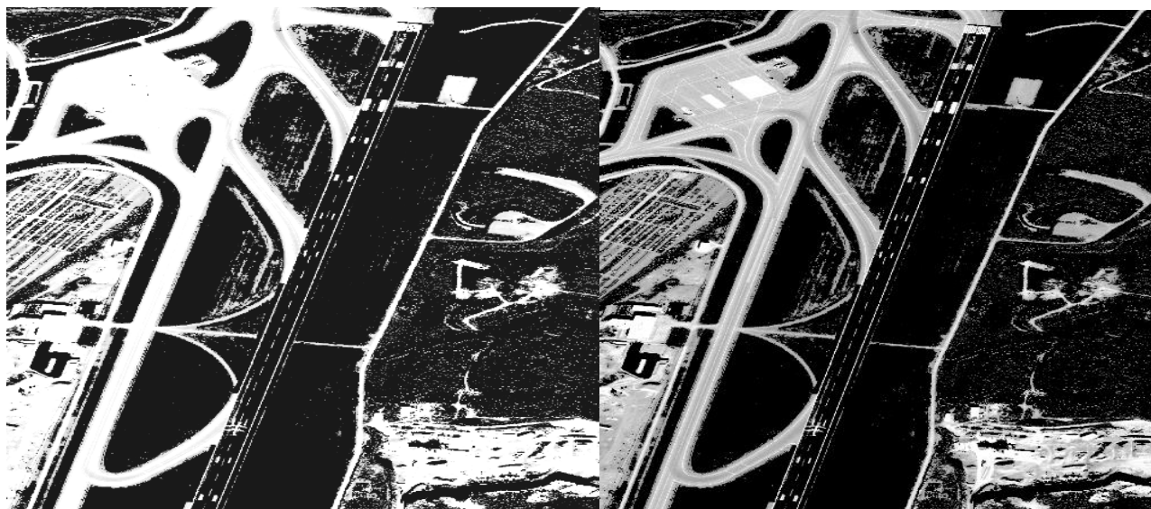
Рисунок 6 - (а) - обробка білатеральним фільтром, (б) - обробка модифікованим білатеральний фільтром
