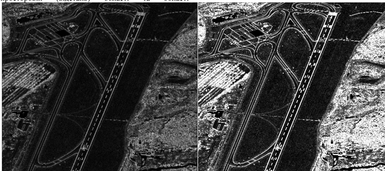
Рисунок 5 - (а) – обробка Гаусівським фільтром, (б) – обробка модифікованим Гаусівським фільтром
