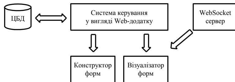
Рисунок 5 – Структурна схема роботи системи візуалізації під час отримання даних від БД з диспетчерського Центру УТАС
