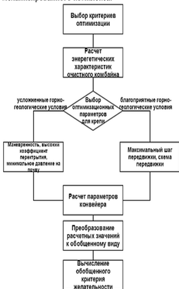
Рисунок 1- Алгоритм вычисления обобщенного критерия желательности для механизированного комплекса
