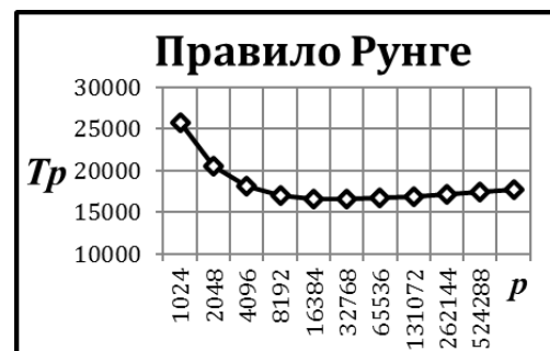
Рисунок 7 – Графики зависимости общего времени на реализацию параллельного алгоритма ЯМРК от числа процессоров p для ВС топологии гиперкуб с параметрами t_{op} = 2, t_s = 25, t_w = 4
