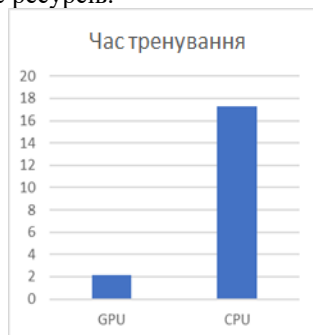
Рисунок 7 — Порівняння часу тренування для GPU та CPU у годинах
