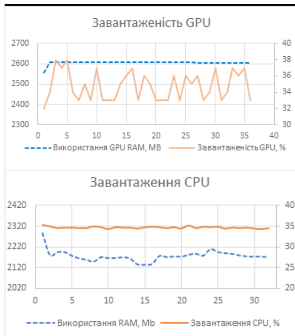
Рисунок 4 — Завантаженість CPU та GPU під час розпізнавання з використанням графічного адаптеру
