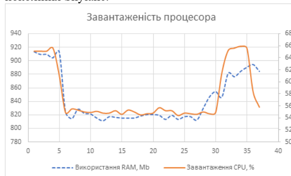
Рисунок 3 — Завантаженість процесора під час розпізнавання з використанням CPU
