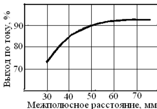
Рисунок 1 – Влияние межполюсного расстояния на выход по току для двух различных конструкций электролизёров.
