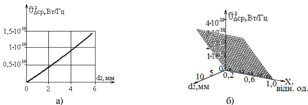
Рисунок 3 – Залежність спектральної щільності потужності шумів пористого діелектричного матеріалу з врахуванням розмірів повітряного пузиря в його структурі
