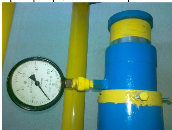
Рис.3. Прибор для измерения усилия вдавливания
