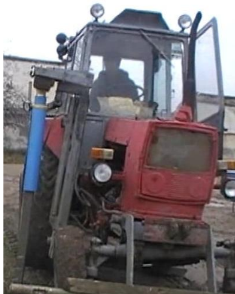
Рис.5. Агрегат для запрессовки виноградных шпалерных опор.
