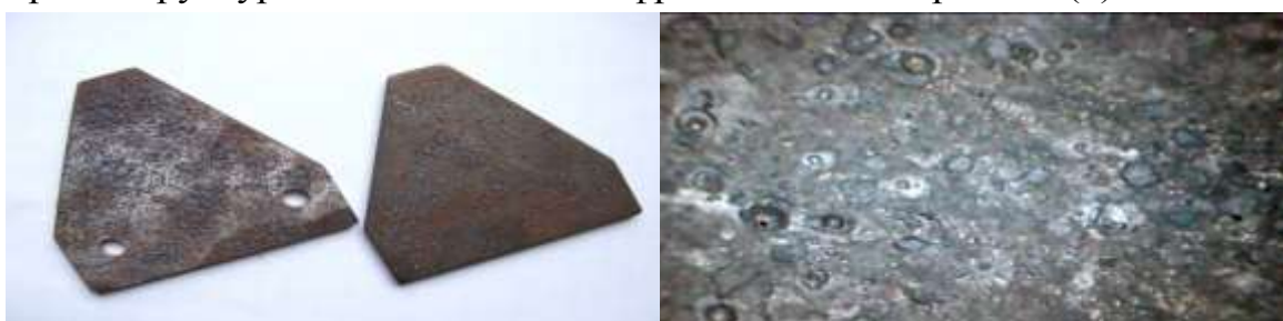
Рис.2 Структура поверхности образца с 25% заполнением порошка: слева- на экспериментальных образцах; справа- после нанесения с увеличением x200
