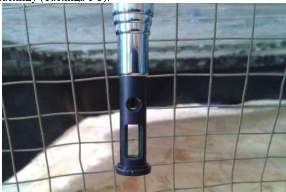
Рис. 5. Измерение воздушного потока в каждой ячейки инфракрасным анемометром
