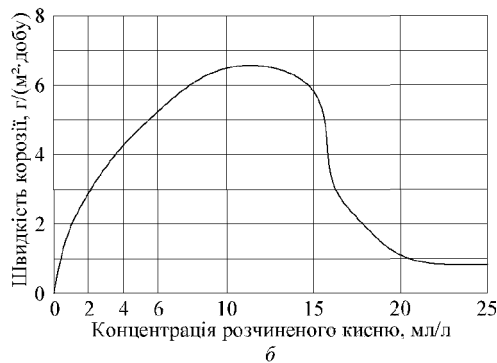
Рис. 2. Вплив концентрації кисню на корозію низьковуглецевої сталі у воді, тривалість дослідів 48 г., температура води 25 °C:
