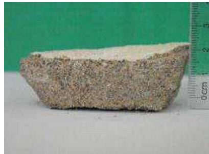
Рис. 3. Глибинна біоцементация піску: рівень біоцементуючого розчину тримався нижче поверхні піску.
