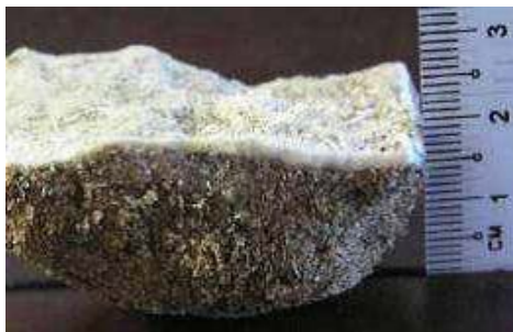
Рис. 2. Твердий поверхневий шар біоцементу на поверхні піску: рівень біоцементуючого розчину тримався над поверхнею ґрунту.
