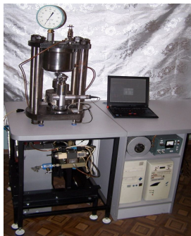
Рис. 2. Загальний вигляд дослідницького комплексу для вивчення компресійних характеристик продуктів
