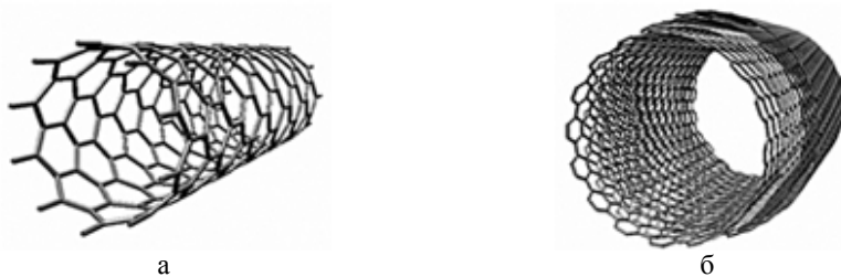
Рис. 2. Схематичне зображення одношарових (а) і багатшарових (б) вуглецевих нанотрубок
