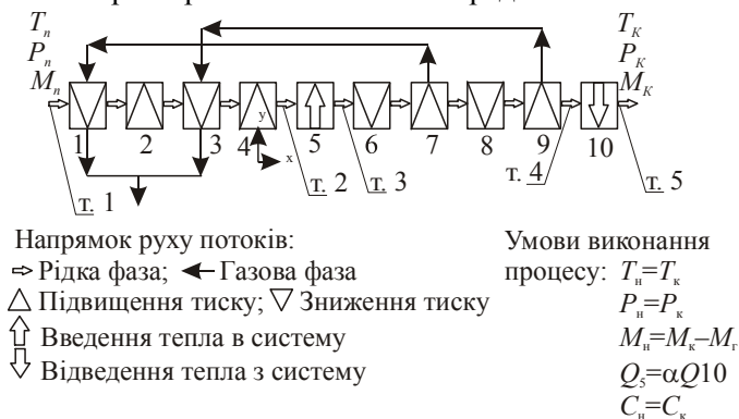
Рис. 1. Принципова схема перебігу термодинамічних процесів термовакуумної обробки рідини (точки відбору зразків позначено як т.1 ÷ т.5): 1 — процес конденсації; 2, 4, 7, 9 — насос відцентровий; 3 — процес конденсації; 5 — процес нагрівання; 6, 8 — процес випаровування; 10 — процес охолодження
