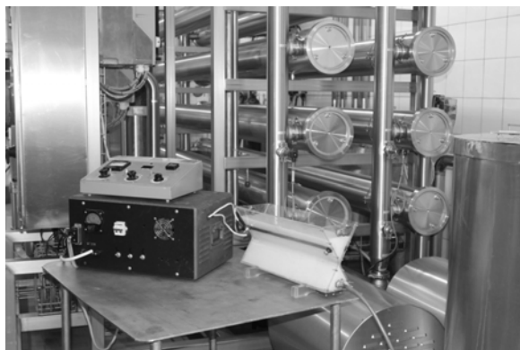
Рис. 1. Фотозображення експериментального технологічного комплексу для електроіскрового оброблення молочної сироватки
