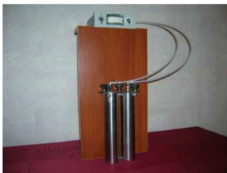
Рис. Лабораторна установка для визначення бродильної активності дріжджів манометричним методом
