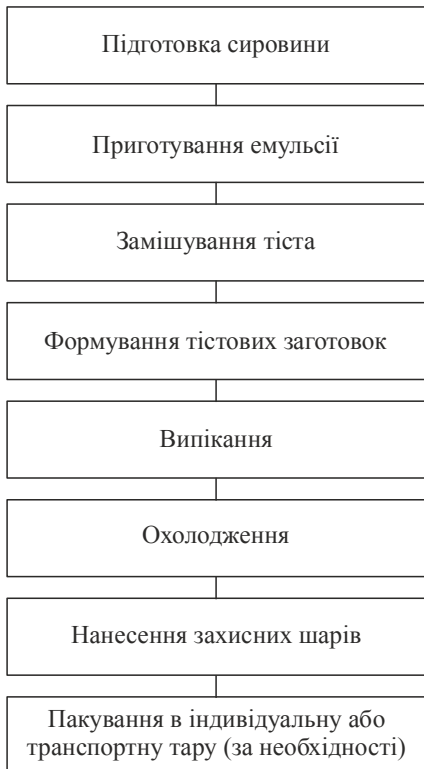
Рис. 3. Принципова схема виробництва борошняного істівного посуду
